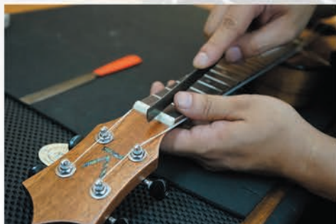
チューニングや弦の鳴りに重要なナットの弦溝を調整。
