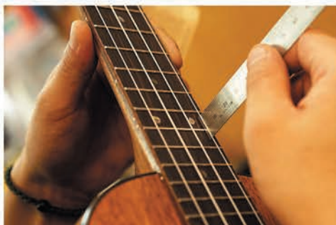
弦と指板のすきまが適正かチェックします。
